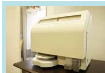
味覚センサー「レオ」。特殊な液体に食品を浸し、容器に入れて左下の円盤にセット。1μl量の物質を取り出し、分析する。
